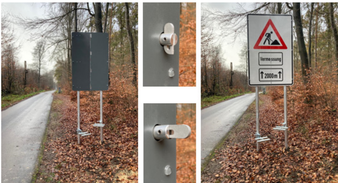
Abb. 3: links Verkehrswarneinrichtung geschlossen, rechts während der Messung
