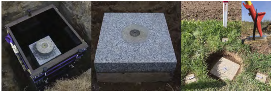
Abb. 8: Umbau und Stativfußvermarkung
