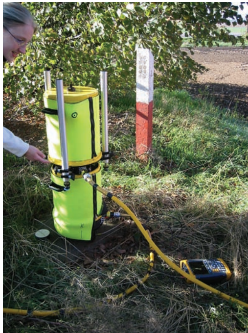
Abb. 2: Das A10 auf einem fundamentalen Schwerefestpunkt Sachsen-Anhalts
