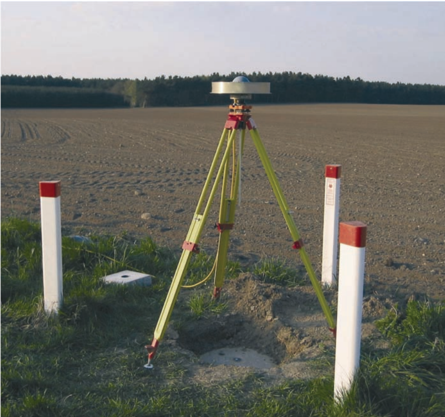
Abb. 6: Der einheitliche GNSS-Stationsaufbau mit GST 20/120 Stativ und Choke Ring Antenne
