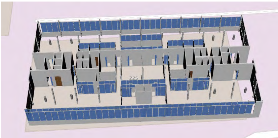
Abb. 4: 3D Modell eines Bürokomplexes und schematische Darstellung der Positionen der CO 2 Sensoren (Zylinder)
