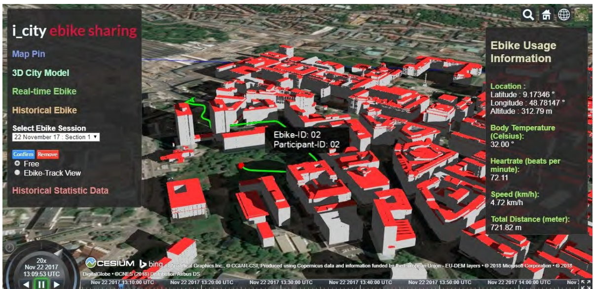
Abb. 3: Visualisierung von E-Bike-Sharing Sensordaten. Messungen der Vital- und Positionssensoren werden in Echtzeit im Kontext eines 3D-Stadtmodells dargestellt. Die gefahrene Route wird als grüne Kurve dargestellt [Santhanavanich 2018].
